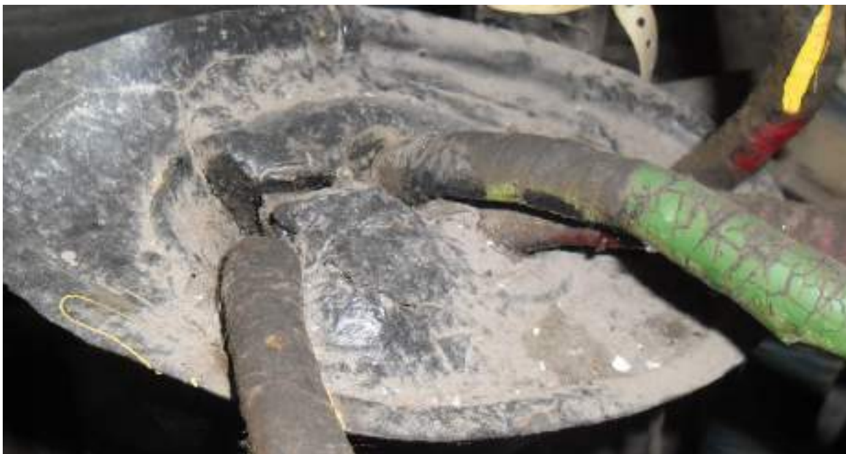
Ф.15 из концевой кабельной разделки происходит обильное выделение масла.
